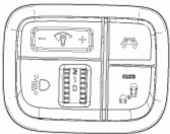
**远光自动控制开关:** 如果组合开关上的灯光开关在自动位置, 且灯光开关置于远光(推动)位置, 远光自动控制系统ON。
